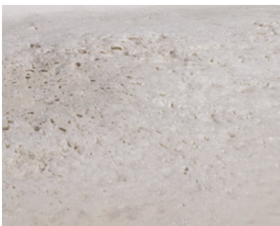
Abb. 1.7: Auftreiben der Rohmasse durch Porenbildung
