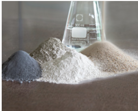
Abb. 1.3: Rohstoffe für die Herstellung von Porenbeton
