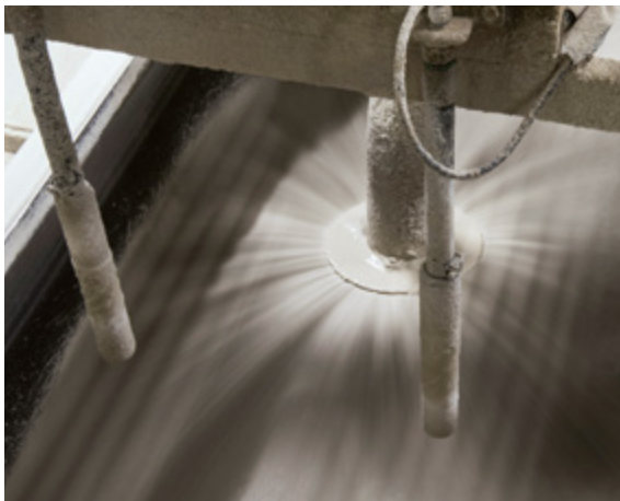
Abb. 1.5: Einfüllen der Rohstoffmischung in Stahlformen
