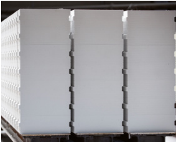
Abb. 1.12: Fertige Porenbetonsteine nach Dampfhärtung im Autoklaven
