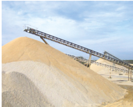
Abb. 1.2: Rohstoffgewinnung Sand für die Herstellung von Porenbeton
