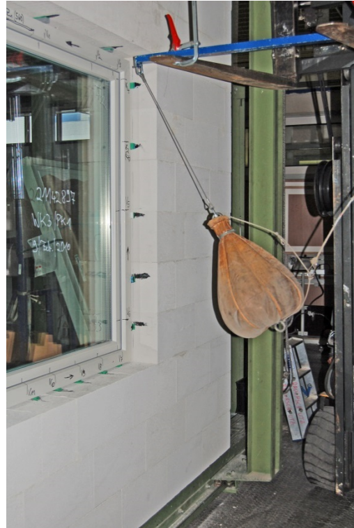
Bild 2: Porenbeton erfüllt die Anforderung für einbruchhemmende Bauteile: geprüfte Wand WK 3 mit einem einbruchhemmenden Fenster im Institut für Fenstertechnik Rosenheim. Dynamischer Versuch während des Tests
