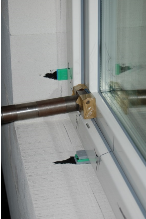
Bild 1: Porenbeton erfüllt die Anforderung für einbruchhemmende Bauteile: geprüfte Wand WK 3 mit einem einbruchhemmenden Fenster im Institut für Fenstertechnik Rosenheim. Statischer Versuch während des Tests
